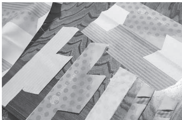
ロール状になった生地を1つ1つ裁断。さらに箸袋の形に裁断・裁縫する。多くの工程を1人で仕上げる。
