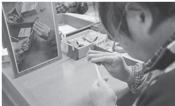
紙やすりを使い、一定の方向に向かって磨きをかける。全員が統一した磨き方をするために目の前に磨き方の写真を置きながら作業を行う。
